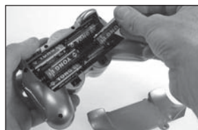
2. 6 x 1,5 V AA batterijen inleggen en op de polariteitsgegevens, zoals in het batterijvak opgegeven, letten.
